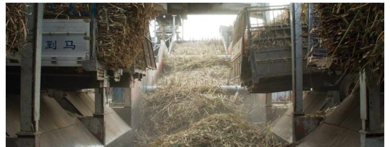
Băng tải mía tại nhà máy sản xuất của TTC Biên Hòa
